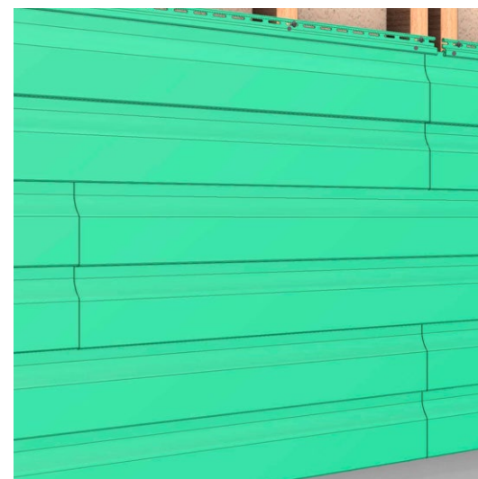
Рис. 24 Смещение стыков панелей сайдинга при стыковке внахлест.
