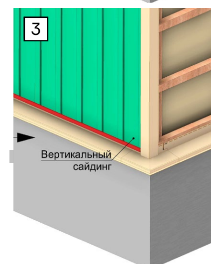
Рис. 29 Подготовка к монтажу вертикального сайдинга Döcke.
